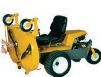
Mise à la verticale du plateau pour faciliter l'entretien et le nettoyage.
