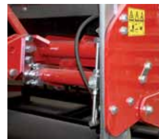
Réglage de la profondeur hydraulique.
