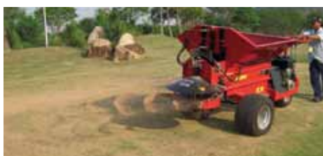
Option Single Side Spinner : Nouvelle technologie de diffusion sur le côté ou à l'arrière de la machine.
