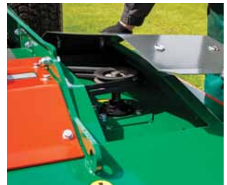
Entretien : facilité d'accès aux courroies.
