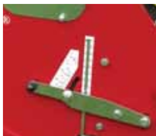
Réglage aisé de l'angle de décompactage par un levier central.
