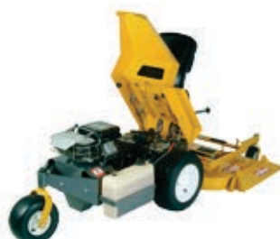
Accessibilité mécanique totale pour faciliter l'entretien.
