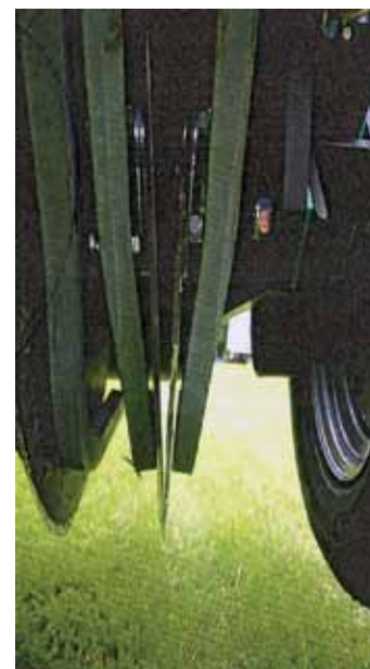
Les semences glissent entre les lames dans le sillon.
