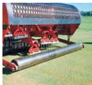
Minipointes Ø 5 mm sur des adaptateurs multipointes
