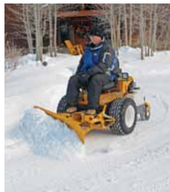
Lame de déneigement - 1,15 m Réf : 12WA605 (MC19, MT23, MD21d) Nécessite l'attelage rapide 12WA603
