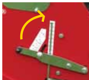
Réglage aisé de l'angle de décompactage par un levier central.
