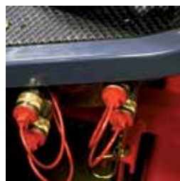
Connexions hydrauliques de serie avant pour accessoires CM 314 &amp; 374
