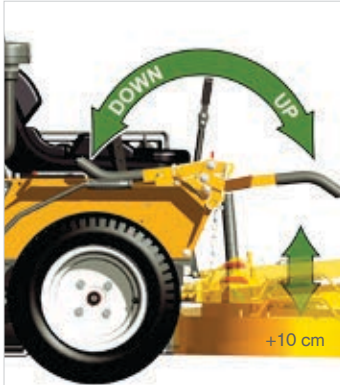
Relevage mécanique de la coupe pour le transport entre différentes zones de tonte Réf : WKR8645 (MC19, MT23, MD21d) Réf : WKR4645 (MB18)
