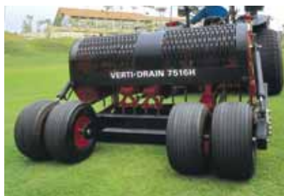
Le système de roues jumelées permet une cylindrée tracteur inférieure.
