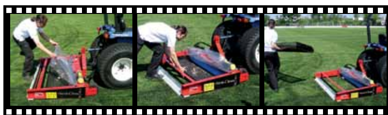
La trémie légère contenant les débris peut être enlevée facilement pour être vidée.
