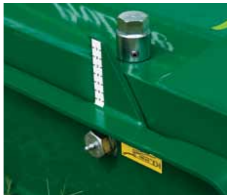
Système de réglage de hauteur de coupe simple.
