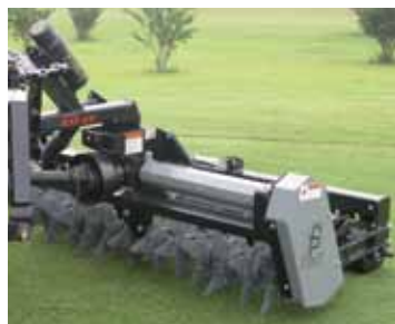
Agrivator, option couteaux vibrants : aération par dents vibrantes des terrains engazonnés.
