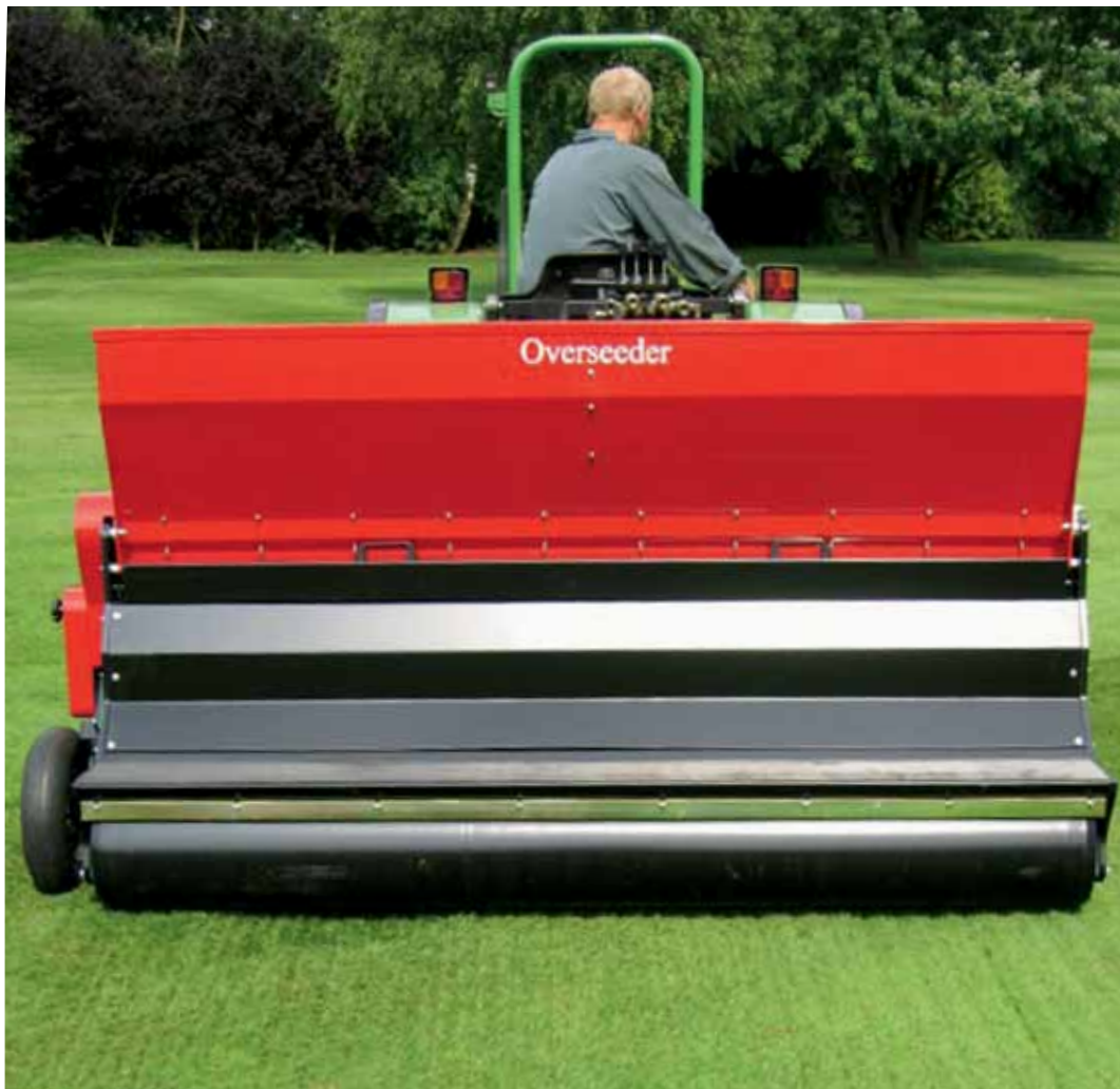
Les semences glissent entre les lames dans le sillon.
