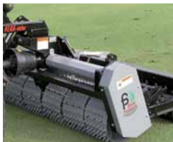
Agrivator, option multi-pointes : regarnissage des terrains engazonnés.
