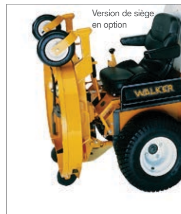
Mise à la verticale du plateau pour en faciliter l'entretien et le nettoyage.
