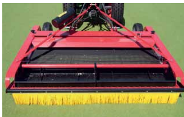
La trémie légère contenant les débris peut être enlevée facilement pour être vidée.
