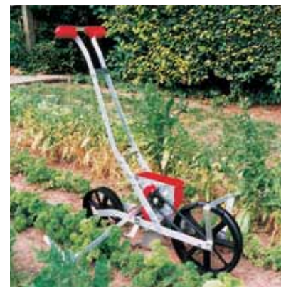
Option localisateur d'engrais (micro-granulateur) Réf : 1173275
