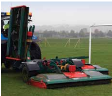
RMX 560 plié pour le transport. Repliage hydraulique.
