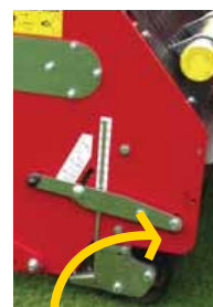
Règlage aisé de l'angle de décompactage par un levier central.
